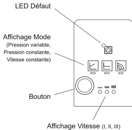
fig. 9 - Affichage sur le boîtier circulateur
