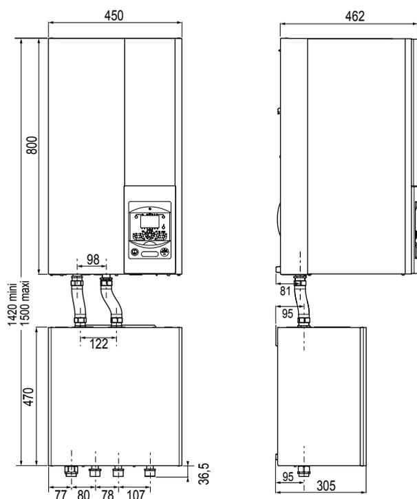
fig. 3 - Dimensions en mm
