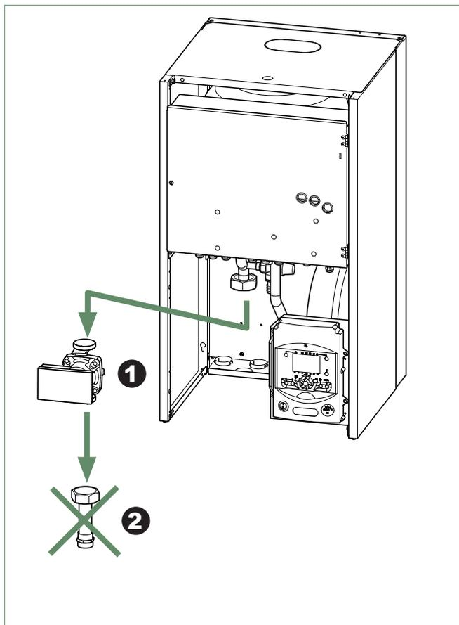
Avec le kit 2 circuits, le circulateur du module hydraulique (CC) **1** doit être déplacé et installé dans le caisson du kit 2 circuits (CC2) **5**.
