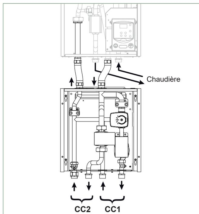
fig. 6 - Montage du kit 2 circuits (PAC + relève chaudière)
