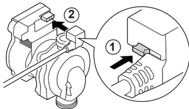
fig. 10 - Raccordement du faisceau circulateur
