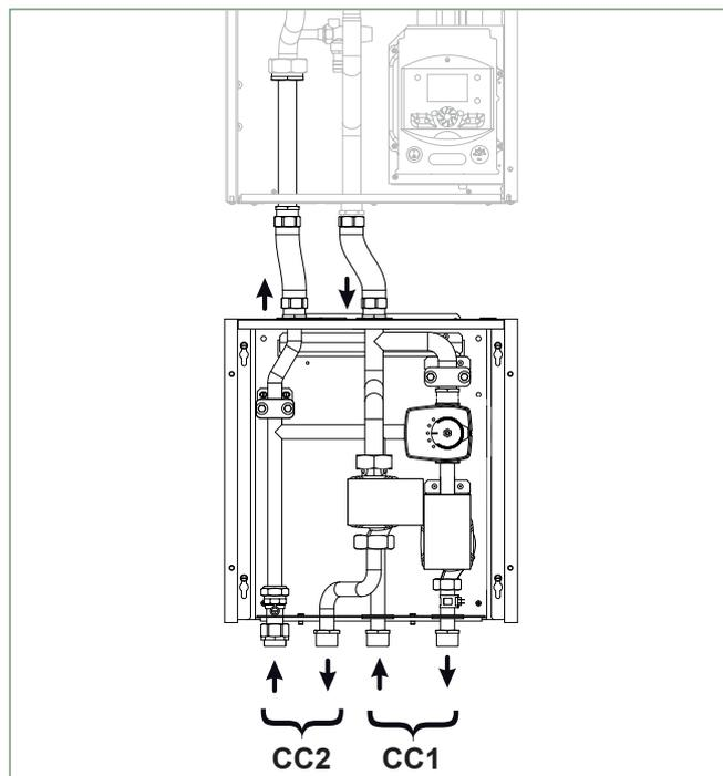
fig. 5 - Montage du kit 2 circuits
