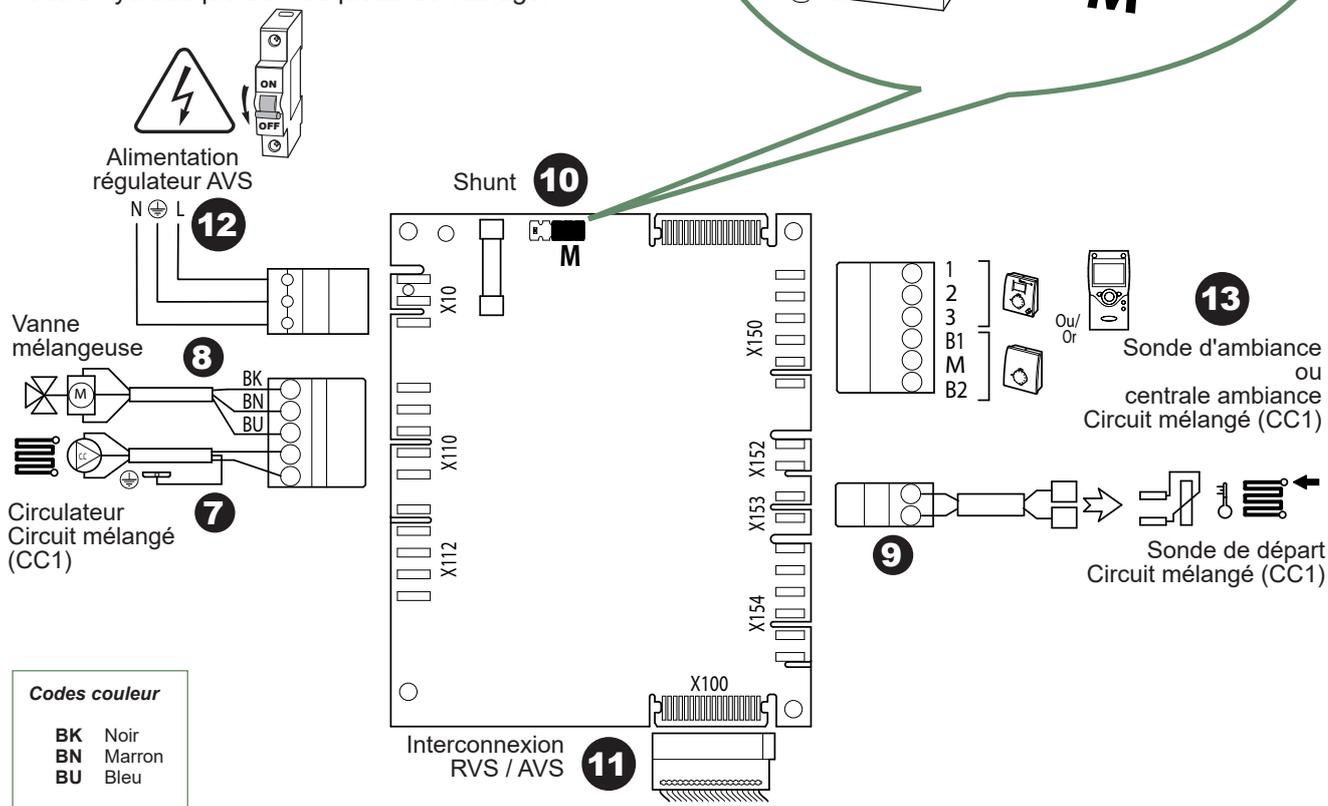
fig. 8 - Câblage électrique pour PAC split (kit 2ème circuit)
