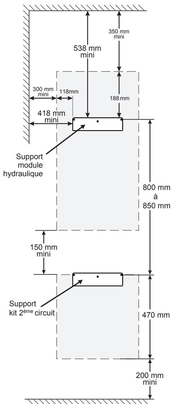
fig. 4 - Fixation du caisson (option 2 circuits)
