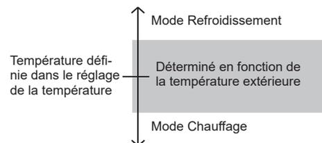
Dans les situations suivantes, le climatiseur démarre le fonctionnement du moniteur pour sélectionner le mode de fonctionnement. Lors du fonctionnement du moniteur, le ventilateur tourne à basse vitesse et s'arrête par intermittence.
