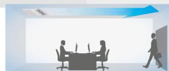
En mode chauffage, l'air chaud est dirigé vers le bas : les pieds et le bas du corps sont chauffés, tandis que la tête reste relativement froide.
