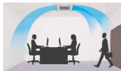
Une climatisation confortable en empêchant le soufflage direct d'air froid et en fournissant simultanément un flux d'air oscillant.
